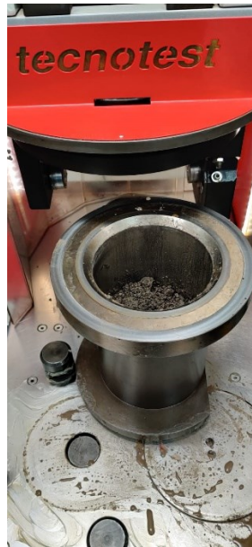
Figura 4.34 - Inserimento della fustella nella macchina
