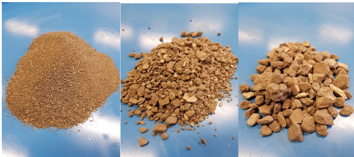
Figura 3.2 – RAP suddiviso nelle 3 frazioni utilizzato nella sperimentazione: da sx fino, medio, grosso
