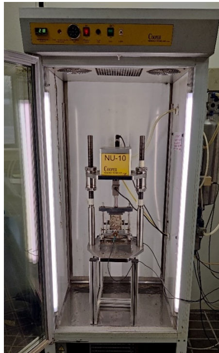
Figura 4.42 - Cella di carico del NAT con al di sotto il castelletto contenente il provino
