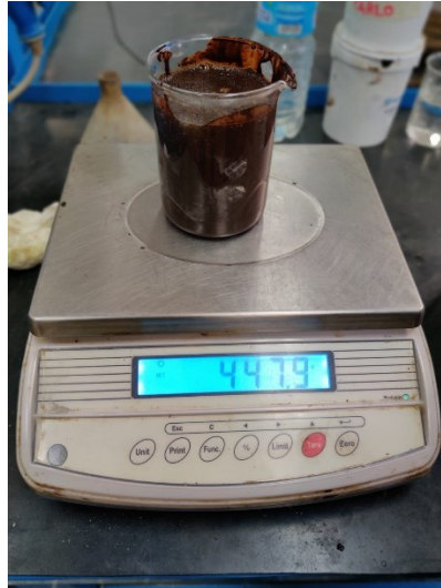
Figura 4.23 - Dosaggio dell'emulsione bituminosa
