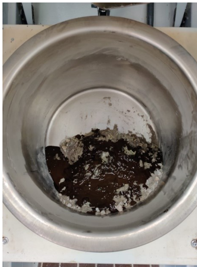
Figura 4.24 - Emulsione bituminosa nel miscelatore
