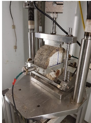
Figura 4.45 - Provino posizionato nella macchina e trasduttori montati
