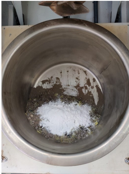
Figura 4.20 – Filler aggiunto nel miscelatore
