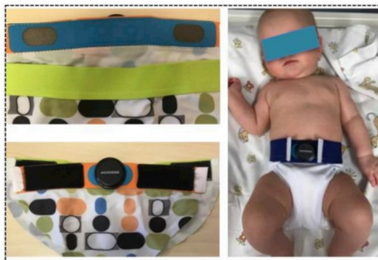
Figura 33: Dispositivo a pantalone per neonati che incorpora elettrodi in tessuto conduttivo, accelerometro e giroscopio per misurare ECG e movimenti [16].
