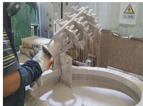
FIGURA 7: IMMERSIONE E RIVESTIMENTO DEL GRAPPOLO NELLA STAFFA; CREAZIONE GUSCIO CERAMICO
