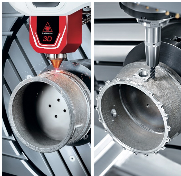
FIGURA 32: PROCESSO DI AM (DED) SEGUITO DA UNA LAVORAZIONE SOTTRATTIVA
