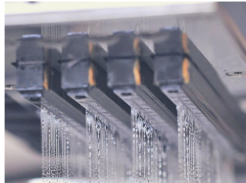
FIGURA 21: GOCCE DI LEGANTE DEPOSITATE
