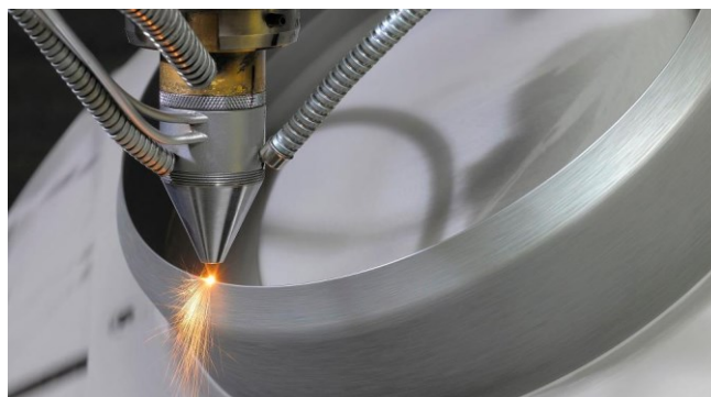
FIGURA 31: FUSIONE DEI FILAMENTI METALLICI TRAMITE LASER
