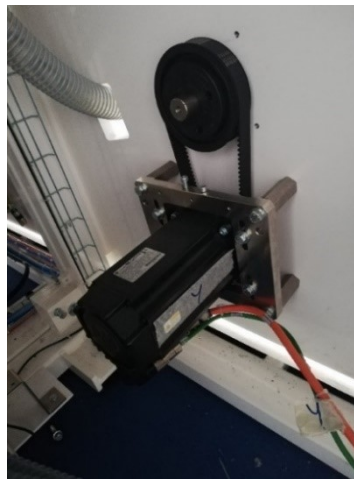
Figura 1.7: Accoppiamento motore brushless al trasporto tramite riduttore di giri.
