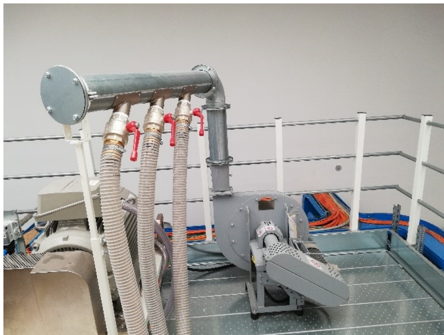
Figura 1.14 Ventola soffiante collegata al mulino.
