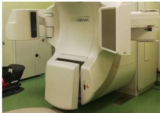
Figura 10. Sistema IGRT incorporato all'acceleratore lineare
