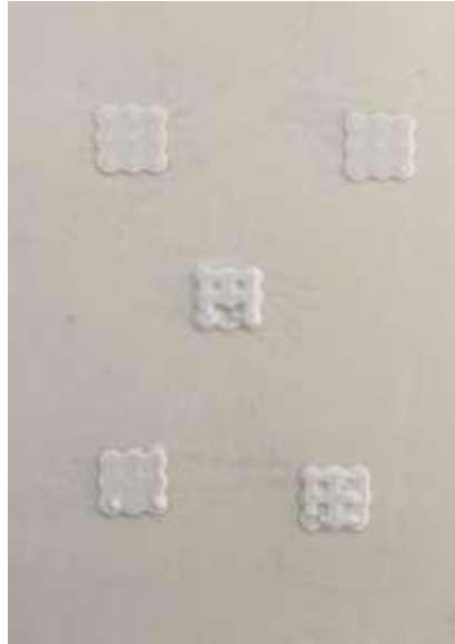
Figura 4.1. Tentativo di stampare ponteggi 6x6x6 mm con altezza dello strato 0,010 mm e 3 secondi di tempo di esposizione normale.
