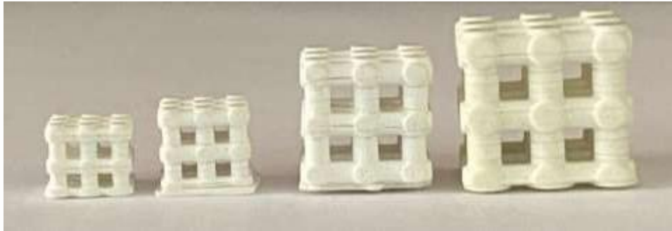
Figura 4.3. Fotografia scaffold non sinterizzati 4,5, 6, 8 e 12 mm di bordo stampata utilizzando un'altezza dello strato 0,025 mm e 6,5 secondi di tempo di esposizione normale
