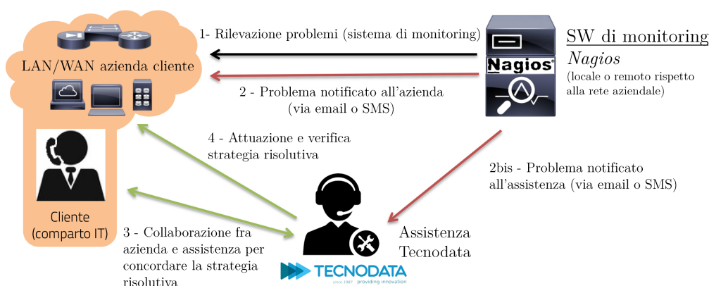
Figura 1.1: Schema del processo di assistenza
