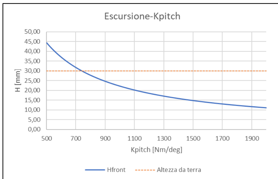
Figura 5.5 - Escursione estremità anteriore vettura vs. rigidezza a beccheggio
