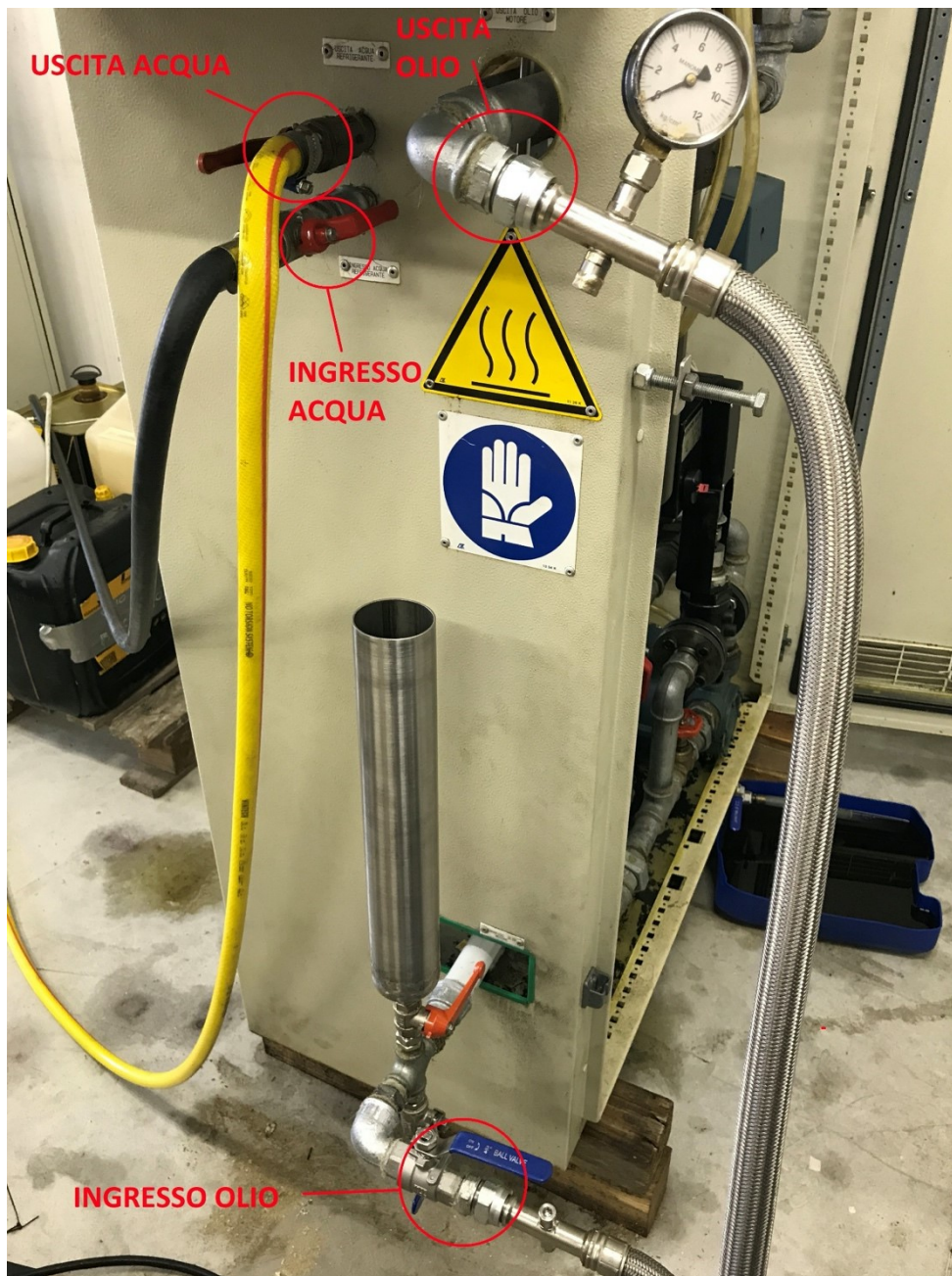
Figura 44: ingressi e uscite di olio e acqua dal CT
