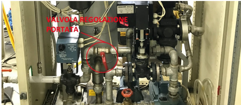
Figura 33: valvola di regolazione portata del circuito termoregolatore
