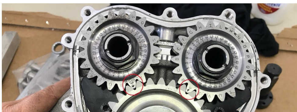
Figura 25: posizionamento corretto della cascata di ingranaggi della distribuzione
