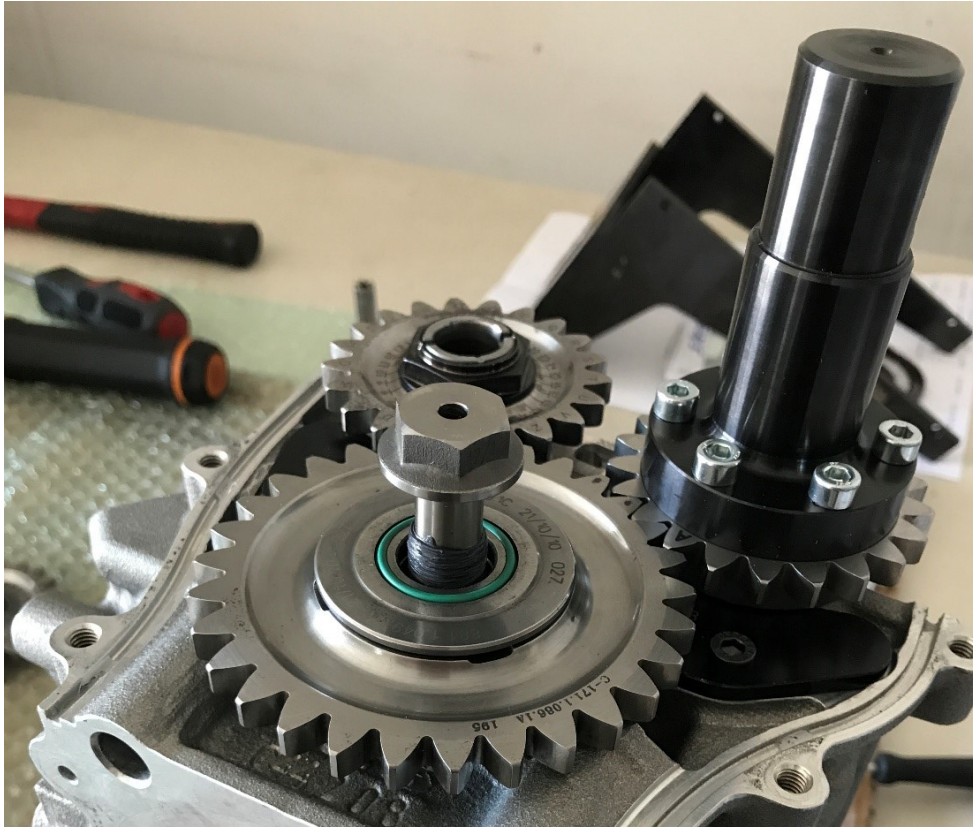
Figura 23: ruota dentata riprogettata con calettato l'albero superfinito e nitrurato di trasmissione
