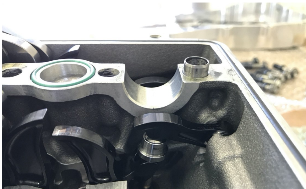
Figura 24: posizionamento corretto dei bilancieri del Desmodromico
