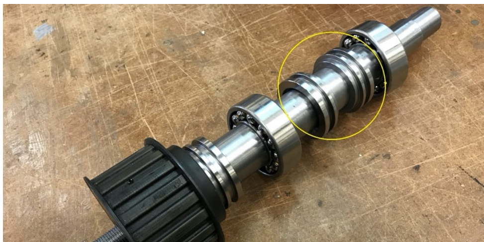
Figura 41: albero di trasmissione assemblato con puleggia dentata, cuscinetti e labirinti
