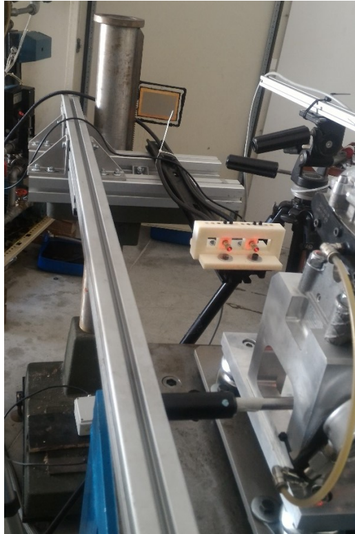
Figura 58: collegamento travi Bosch e colonna di supporto del trapano a colonna
