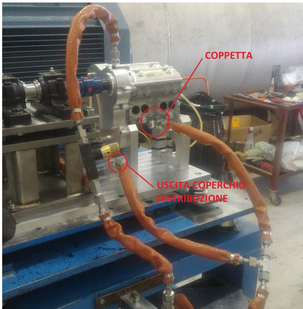
Figura 36: ingresso e uscita olio dal coperchio distribuzione, uscita olio testata e snodo a T
