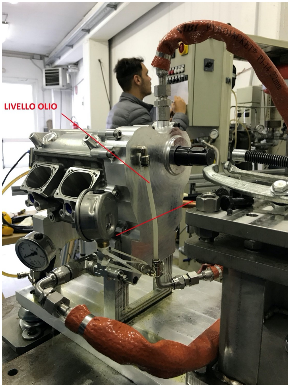
Figura 50: indicatore livello olio con rispettiva linea che indica l'allagamento necessario nel coperchio distribuzione
