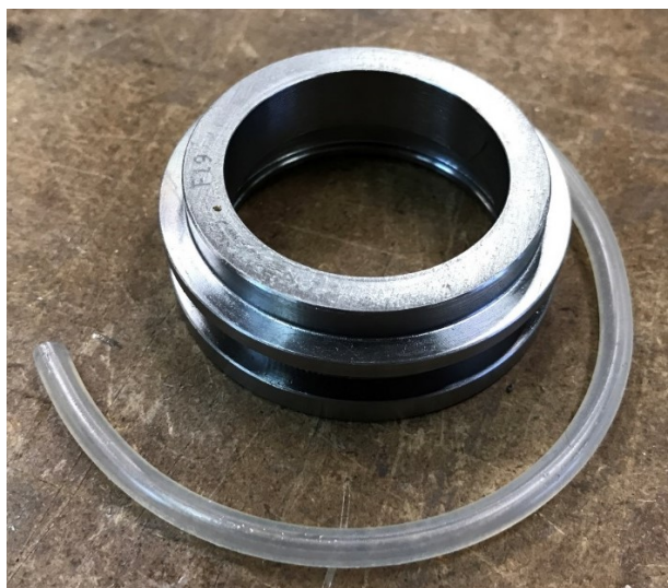
Figura 40: labirinto con tubo gommato per evitare la fuoriuscita del grasso presente nel giunto
