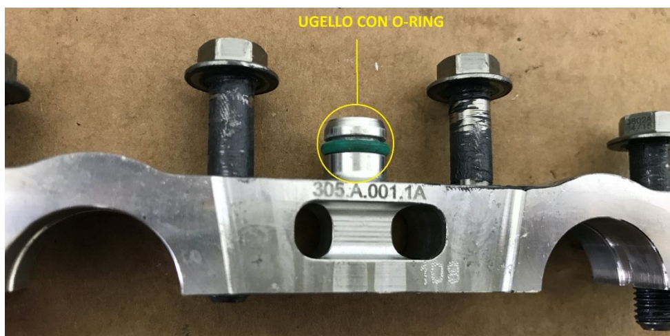
Figura 19: particolare ugello olio con o-ring del cappello cammes
