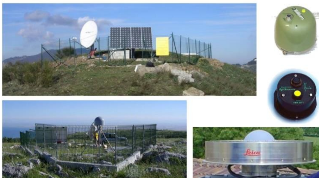
Figura 12: Sito della rete RSN-RING dotate di velocimetro a banda larga, accelerometro e antenna GPS
