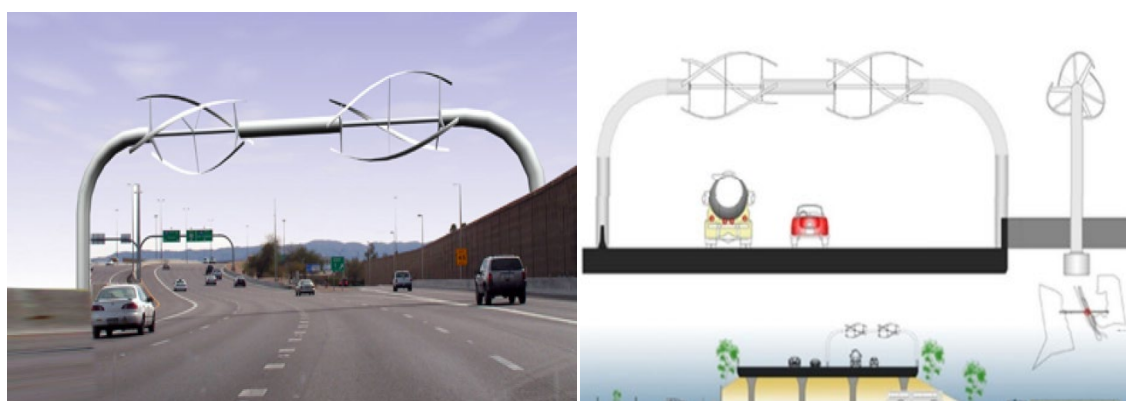
Figura 34,35 – Progetto turbine eoliche integrate nei divisori autostradali
