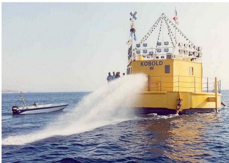
Figura 54,55 – Generatore a corrente di marea con la turbina Kobold (stretto di Messina)
