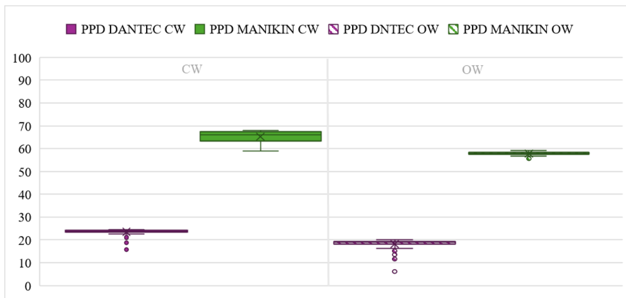
Figura 129_Grafici box plot dei dati PPD acquisiti con la Dantec e con il Manichino sia in condizioni di finestre aperte (OW) che in condizioni di finestre chiuse (CW) per la scuola di Falconara
