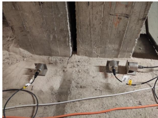
Figura 4.1.4 accelerometri posti in prossimità del giunto
