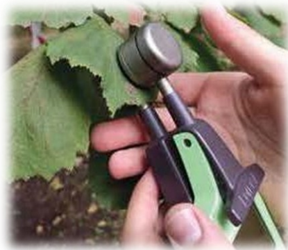
Figura 3-6: Esempio di rilievo eco-fisiologico non distruttivo su foglia di nocciolo con impiego di fogliarimetro digitale (Dualox)
