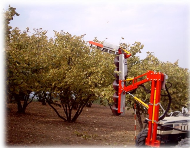
Figura 3-1: Potatura meccanica del nocciolo
