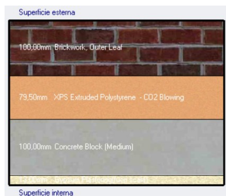
Figura 50 Sezione parete esterna (Parete 3) DesignBuilder
