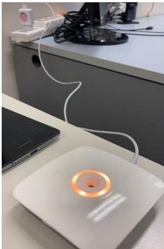
**FIGURA 23.** *Comfort Air in modalità ON, collegato a una presa di corrente. Il colore rosso in figura indica una scarsa qualità dell'aria*
