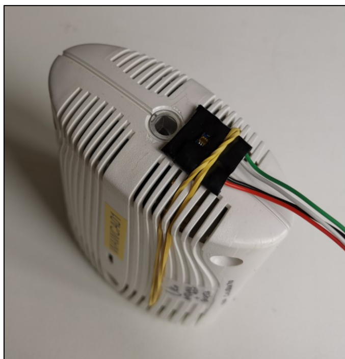
Figura 20 - Posizionamento del sensore di riferimento TSL2591 sul Comfort Air
