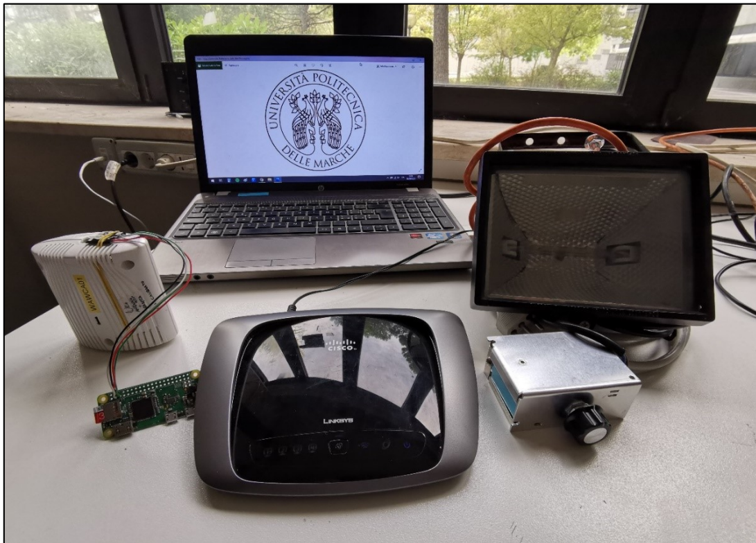
Figura 21 - Dispositivi utilizzati per l'acquisizione dei dati (da sinistra Comfort Air, sensore di riferimento TSL2591, Raspberry Pi 0, laptop, router, faretto alogeno, dimmer)
