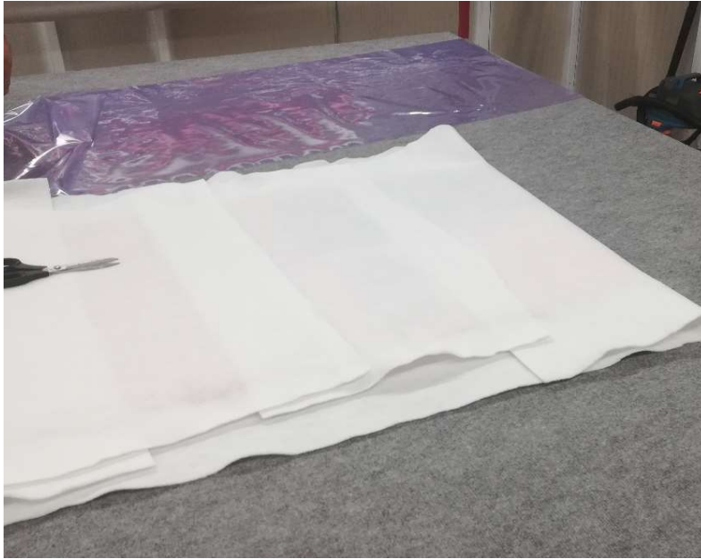
Figura 52, esempio di laminazione manuale: aggiunta del breather e preparazione del sacco da vuoto
