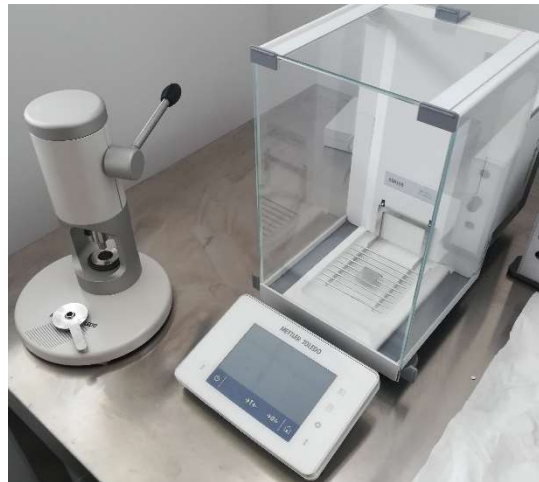
Figura 12, bilancia e pressatore per DSC
