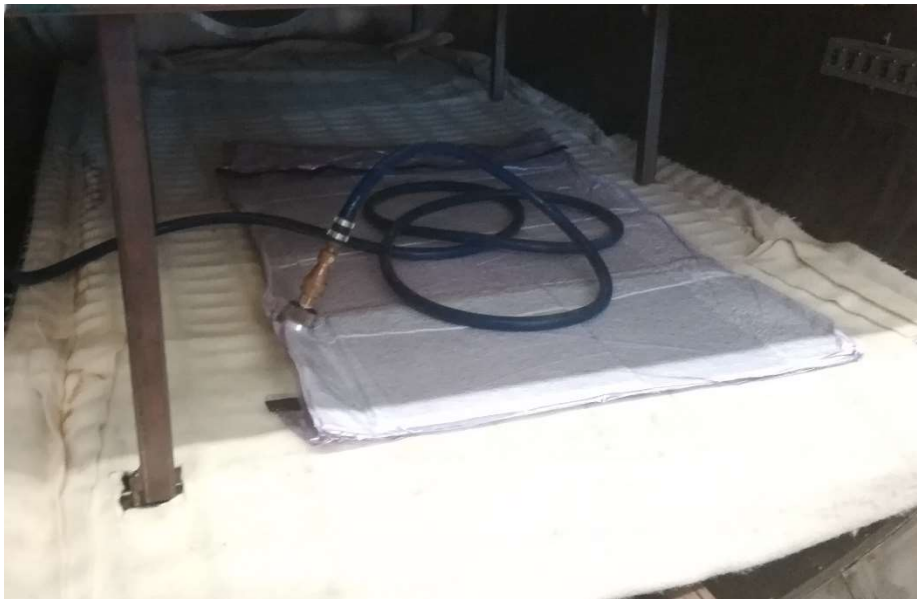
Figura 53, esempio di laminazione manuale: stampo finito ed inserito in autoclave, pronto per il ciclo di cura
