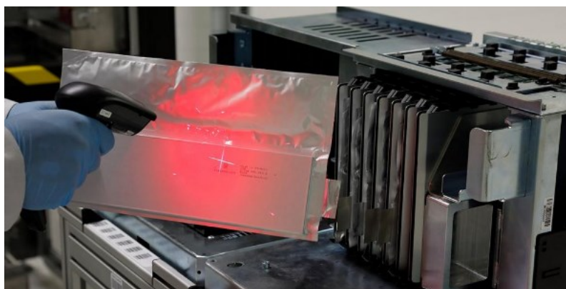
Fig. 3: disposizione dei pouch nel modulo batteria
