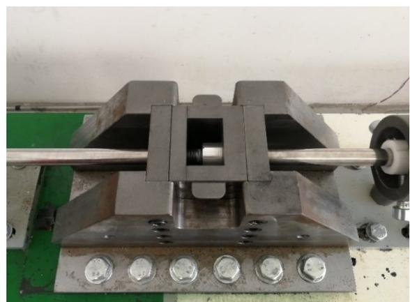
**(b)** Blocco rigido pronto per il test
