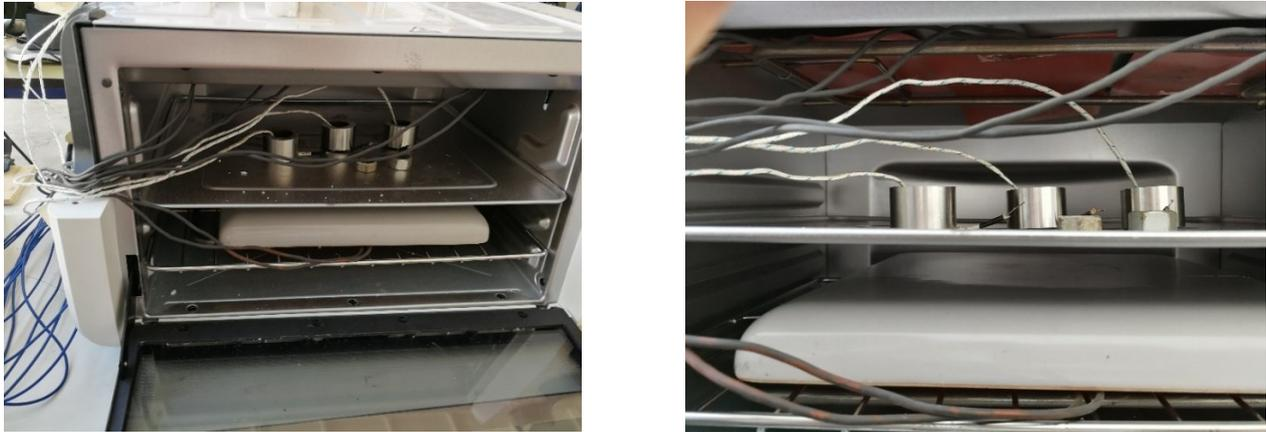
**Fig. 3.1.3** Forno usato per riscaldare i provini. Nella mezzeria si notano (fili bianchi) i tre terminali delle termocoppie. Nel piano sottostante ed in quello soprastante sono poste le resistenze.
