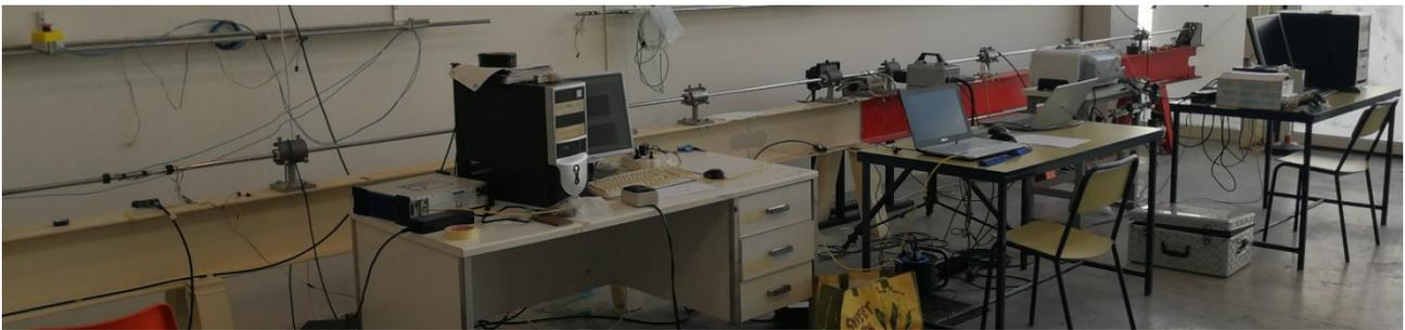
**Fig. 2.3.1** La barra dell'UNIVPM: il colore delle travi HEA serve per distinguere i vari tipi di barre. Sopra il verde sta la barra di pretensionamento. Sopra il bianco sta la barra di input. Sopra il rosso sta la barra di output. Nelle immagini è presente la strumentazione pronta per un test.
