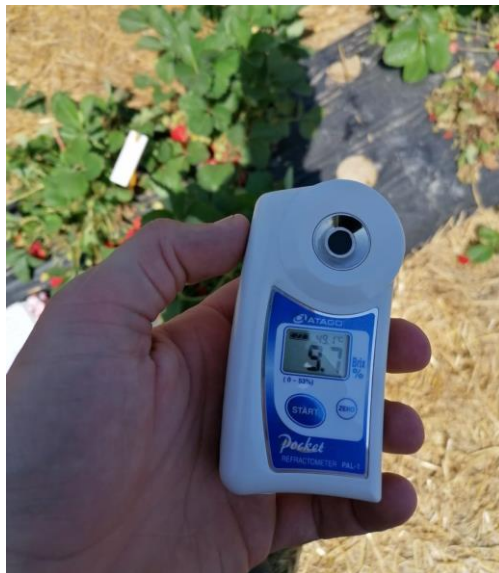
Figura 7: Rifrattometro digitale Atago durante l'utilizzo per l'analisi del °Brix
