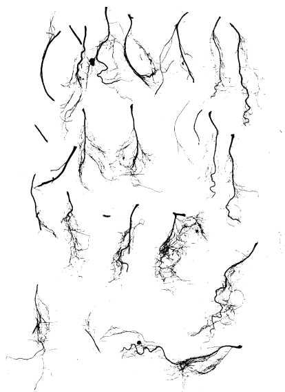
Figura 28: modello del file .TIF dopo la scansione. Con il software WinRHIZO selezioni l'area d'interesse e ti viene calcolato
