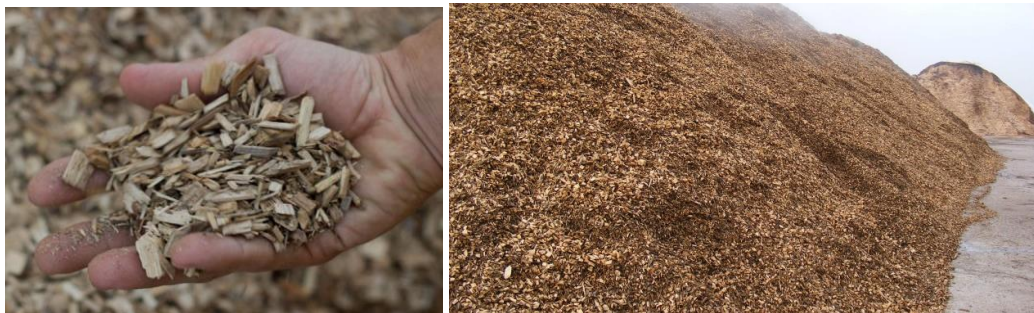
Figura 2-1: Cippato di legno (sx) cumulo in piazzale (dx)
