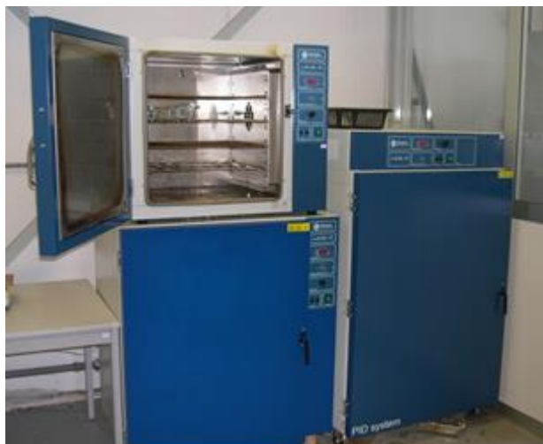
Figura 1-4: stufa termo ventilata (Laboratorio biomasse).
