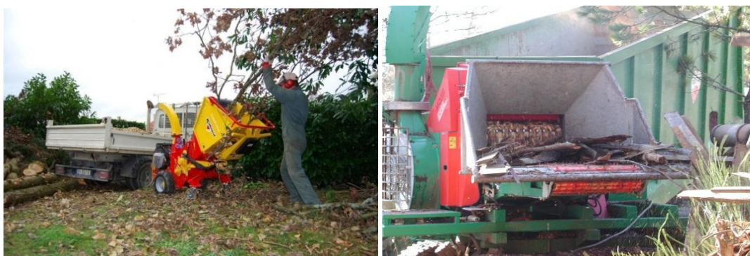
Figura 2-8: Esempi di sistemi di alimentazione
