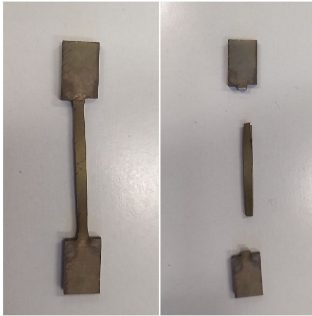
Figura 7. Foto di un provino prima e dopo essere stato tagliato.
