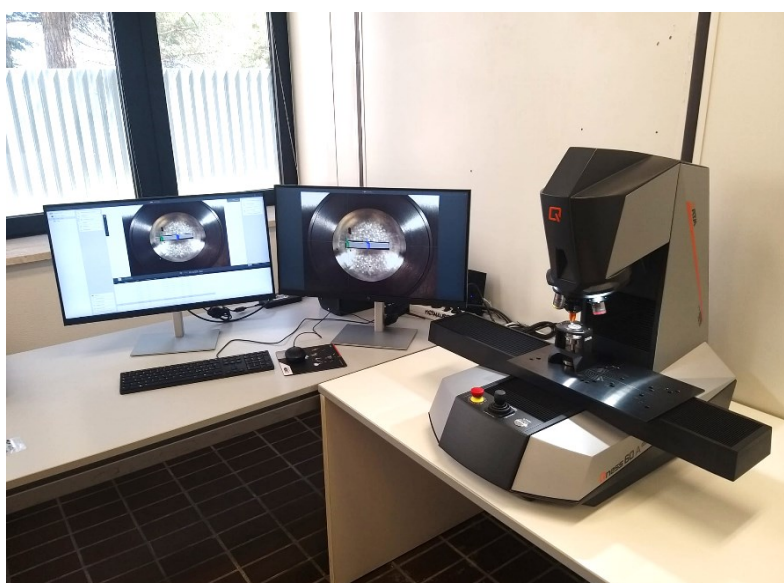
Figura 12. Foto del microdurometro di ultima generazione con postazione di lavoro.
