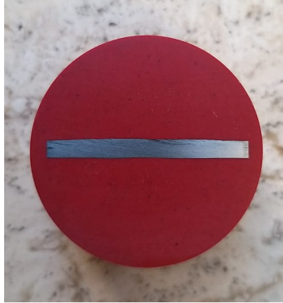
Figura 10. Foto di un campione inglobato e lucidato.
