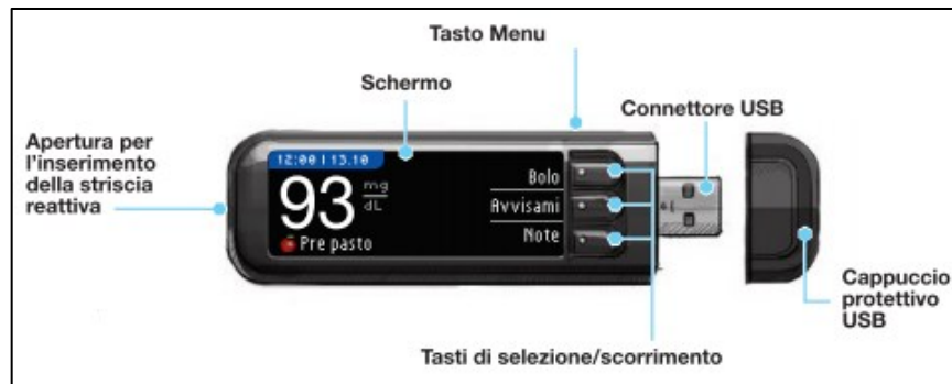
Fig. 5 Glucometro Next Link 2.4 di Ascensia diabetes care Fonte: Manuale di istruzioni Contour Next Link 2.4 2017, Ascensia Diabetes Care.
