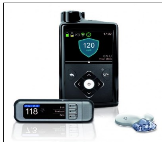
Fig. 6 Sistema di controllo della glicemia ad ansa chiusa MiniMed 670G.
