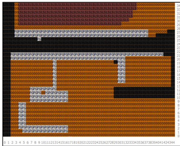
Figura 4.9 Soil and surface dell'area della simulazione con marciapiede in calccestruzzo chiaro visualizzata in Spaces, ENVI-met
