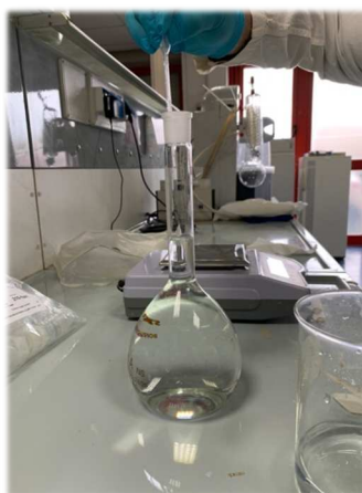
Figura 5-9: Matraccio da 1 L con soluzione estraente
