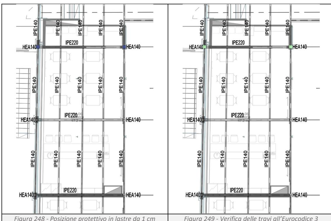
Figura 248 - Posizione protettivo in lastre da 1 cm
