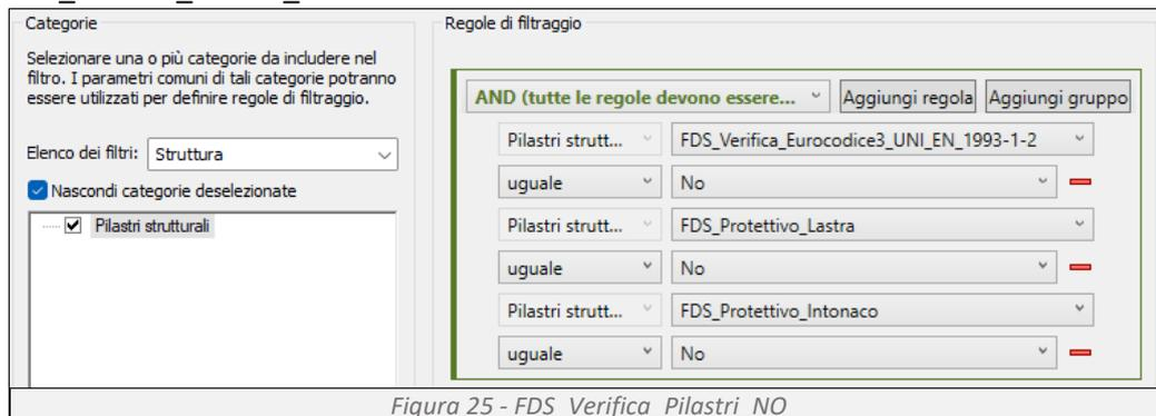
Il filtro viene applicato ai pilastri e determina la risposta grafica del programma se l'elemento strutturale, sprovvisto di strati protettivi, non verifica ai requisiti dell'Eurocodice 3 (Figura 25).
