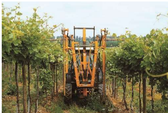
Figura 2-1: Cimatrice a barre falcianti in un vigneto di Bonarda ( Poni et al., 2004 ).
