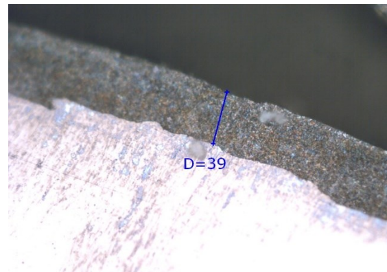
Figura 4.1.3 Campione G, settore 2, spessore massimo e minimo del rivestimento totale
