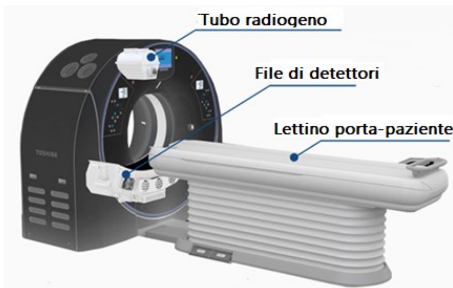
Figura 1. Rappresentazione schematica dei componenti di uno scanner TC.
