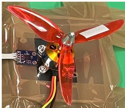
*Figura 19: sistema motore-elica di drone con accelerometro*
