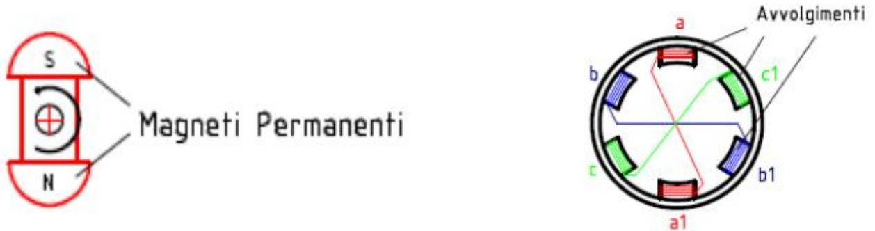
Figura 16: schema del rotore a magneti permanenti e statore ad avvolgimenti
