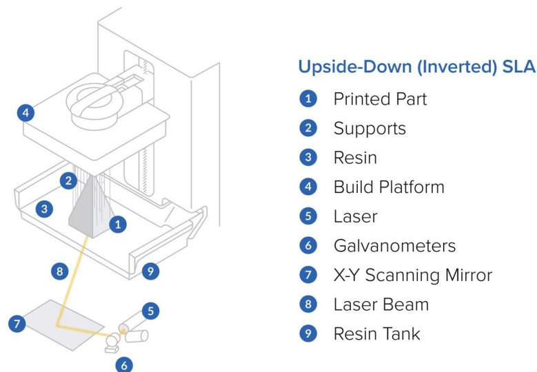
Figura 4 - Schema funzionamento stampante SLA
