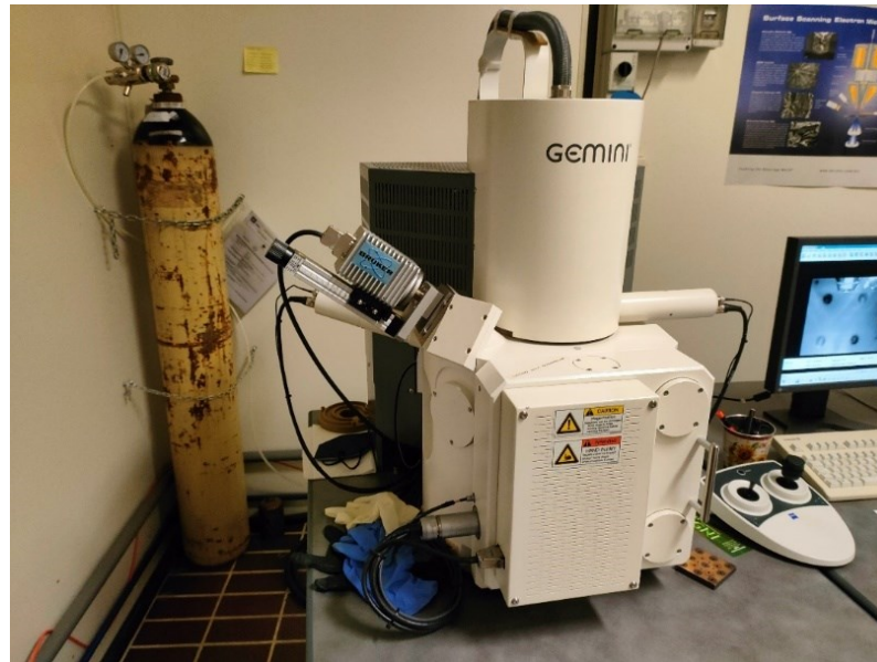
Figura 32 - Microscopio SEM Zeiss Supra 40 con relativa riserva di azoto
