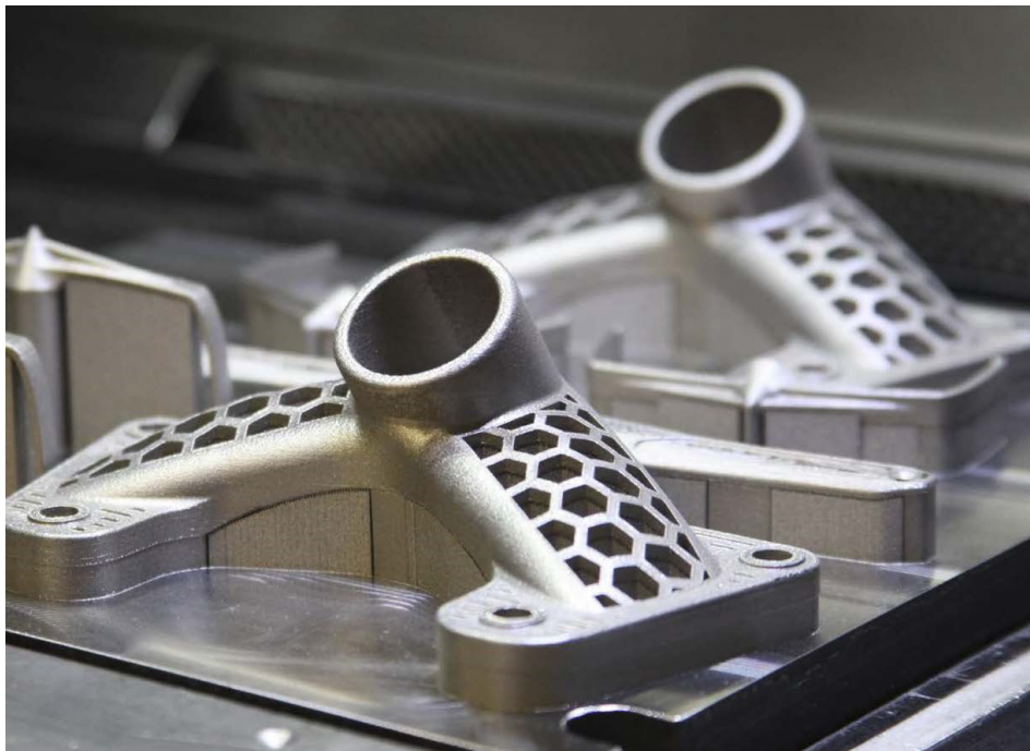
Figura 8 - Componente realizzato tramite L-PBF con relativi supporti
