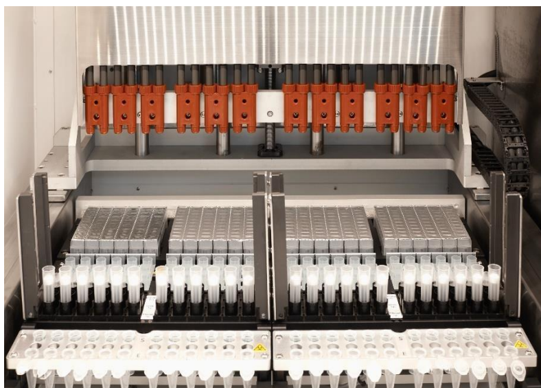
FIGURA 8: Area interna di lavoro dell'estrattore MagPurix2000, in cui vengono caricati i campioni (di sangue o tampone boccale), le cartucce con biglie e soluzioni tamponate per l'estrazione e le eppendorf per l'eluato (protocollo MagPurix2000).
