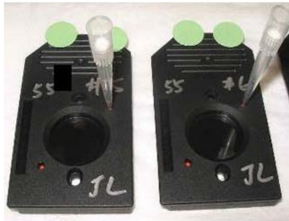
FIGURA 19: si deve inserire la punta di un puntale da 200 \mu l nel setto in alto a destra di ciascun array, in modo tale da creare aria all'interno. Nel foro in basso a sinistra si inserirà il campione fino a riempimento.
