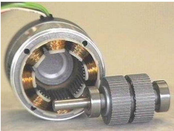
Figura 6: struttura interna di un motore passo passo
