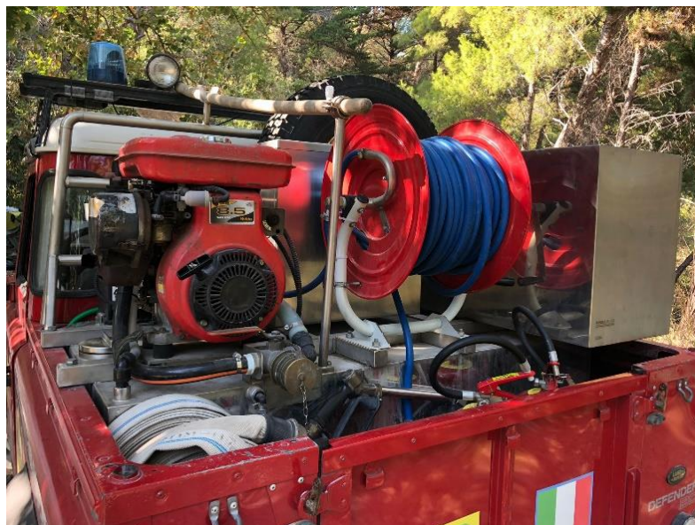
Figura 8. Modulo idrico, 400L, Naspo 100 metri. Dotazione VAB Marche (archivio personale)
