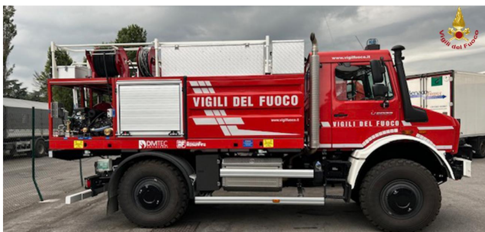
Figura 5. Autobotte A.I.B. con modulo idrico scarrabile. (archivio online VVF)
