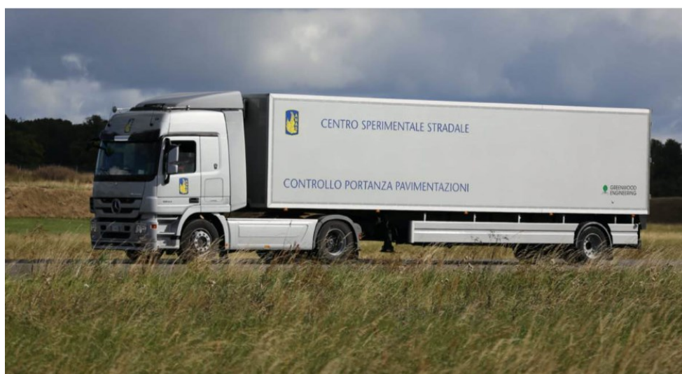
Figura 2.13 Traffic Speed Deflectometer Greenwood in dotazione di ANAS
