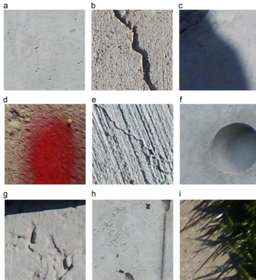
figura 5.3: “SDNET2018” include immagini di: a)crepe sottili, b)crepe grossolane, c)ombre, d)macchie, e)superfici con imperfezioni, f)buchi, g)bordi, h)giunzioni e i)ostacoli sullo sfondo <sup>28</sup>
