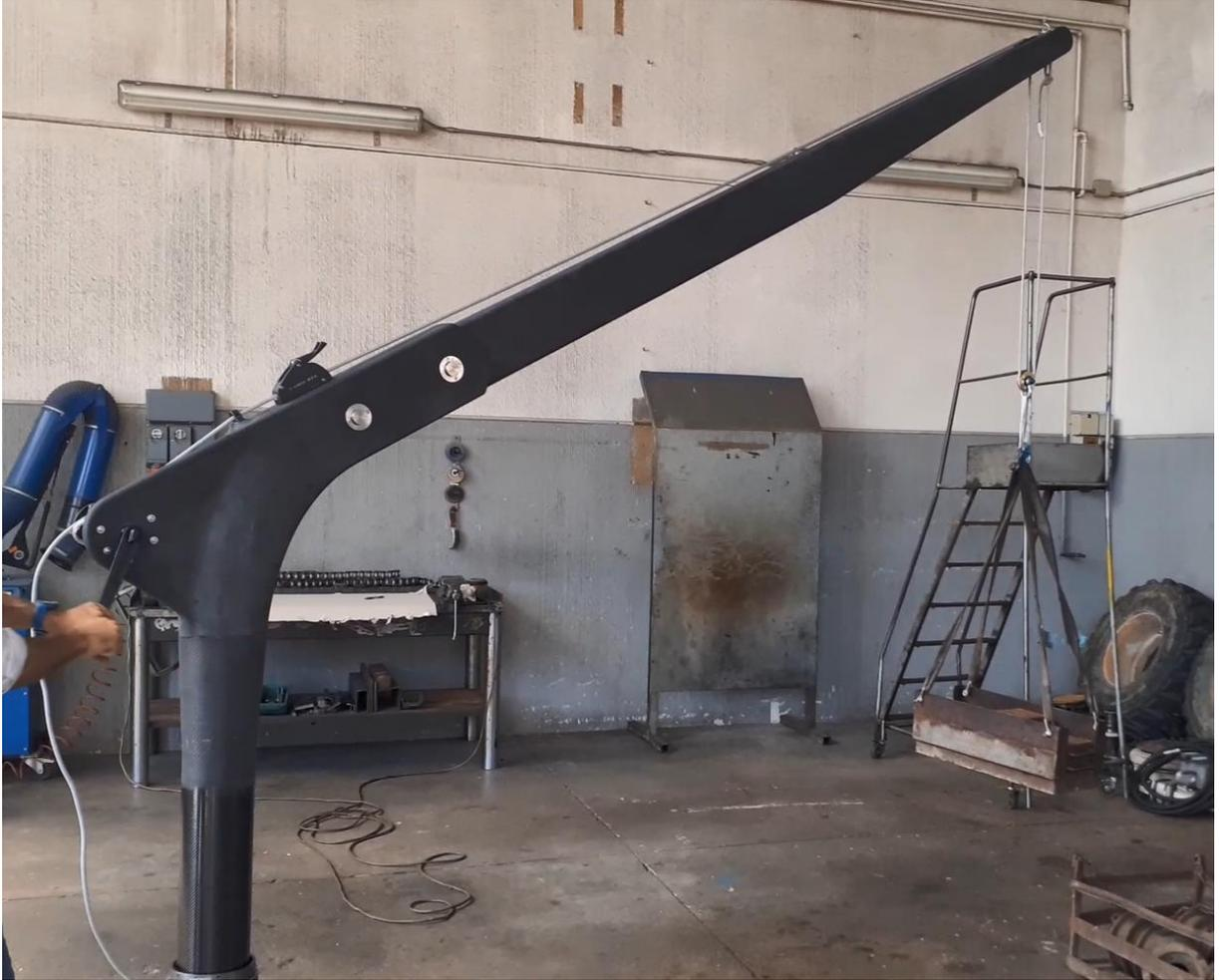
*Figura 73: INSERIMENTO DEL CARICO E PROVA DI SOLLEVAMENTO*
