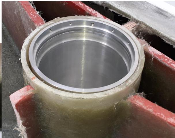
*Figura 58: STRUTTURA PORTANTE DEL BICCHIERE*
