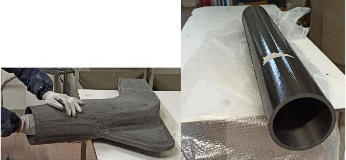
*Figura 70: PREPARAZIONE CURVA E PALO PER INCOLLAGGIO*
