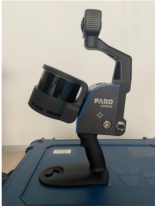
Figura 3-1: Laser scanner Orbis™ di FARO
