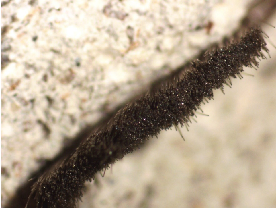
Figura 50 - Immagine a 8X del provino CEM 600°C- fibra
