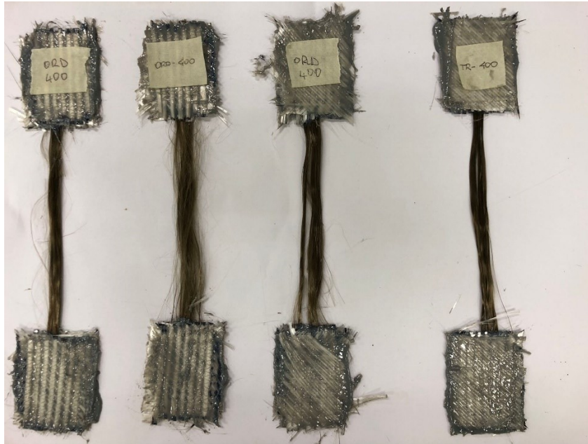
Figura 21 - Provini per la prova a trazione a 400°C
