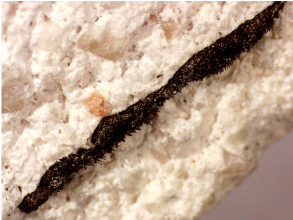
Figura 57 - Immagine a 8X del provino LIME-400°C
