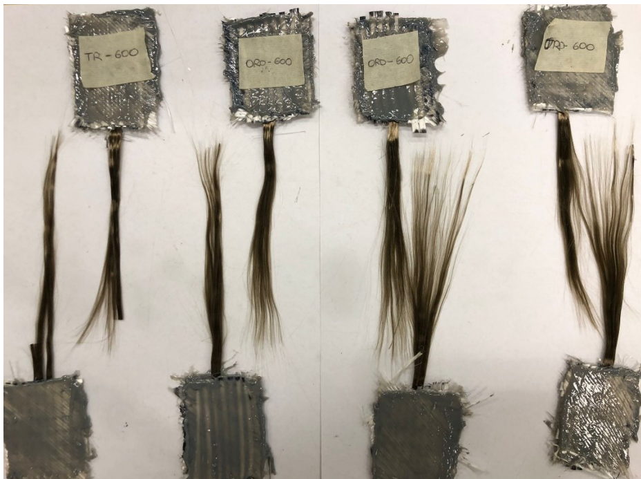
Figura 71 - Provini a 600°C dopo la prova di trazione
