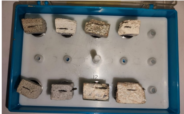
Figura 18 - Provini per osservazioni al SEM e al microscopio
