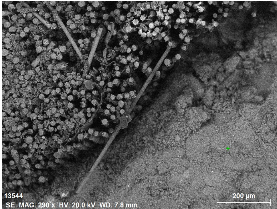
Figura 33 - Mappa bidimensionale CEM400 a 290X
