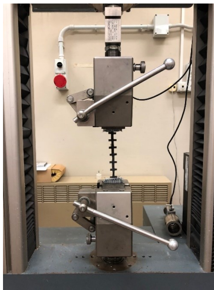
Figura 63 - Setup prova a trazione
