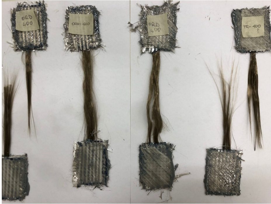
Figura 70 - Provini a 400°C dopo la prova di trazione
