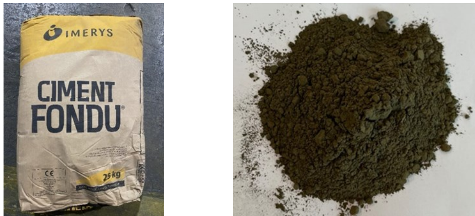
Figura 13 - Polvere di cemento alluminoso usato per ridurre i fenomeni di efflorescenza.
