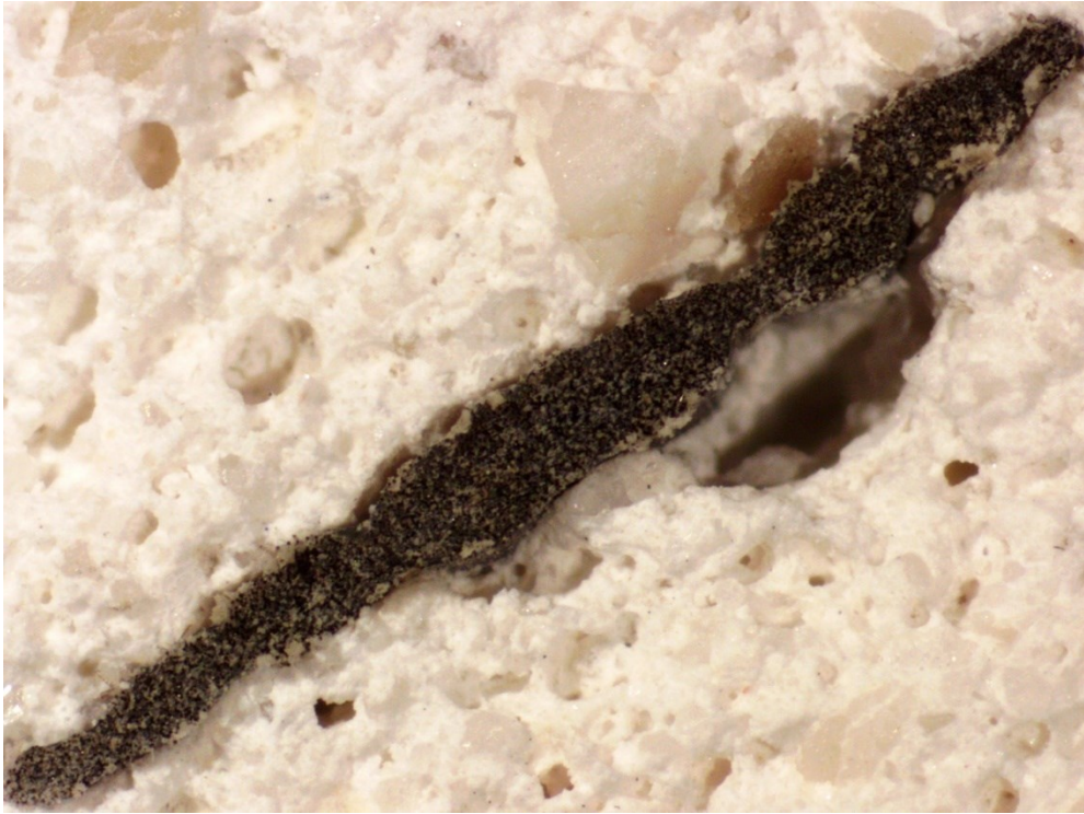
Figura 56 - Immagine a 8X del provino LIME-200°C
