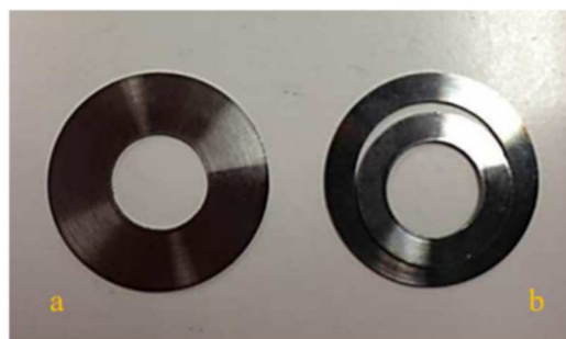
Fig. 5: Disco cavo di materiale fragile per il sistema di tranciatura, a) prima del test, b) dopo del test.
