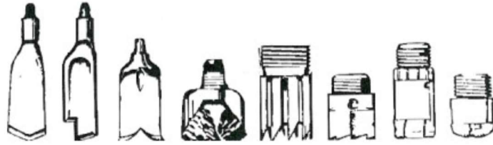
Figura 13- Punte tipicamente utilizzate per la disaggregazione del terreno
