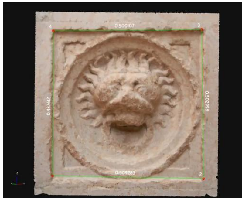
Messa in scala di una Mesh utilizzando le misure degli spigoli interni (Bigliardi, 2017)
