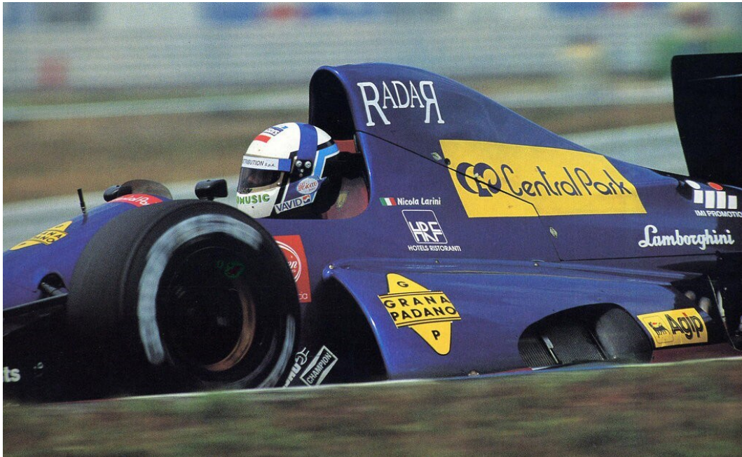
Figura 3.8: La Lambo 291 del Modena Team, caratterizzata da bocche di ingresso triangolari
