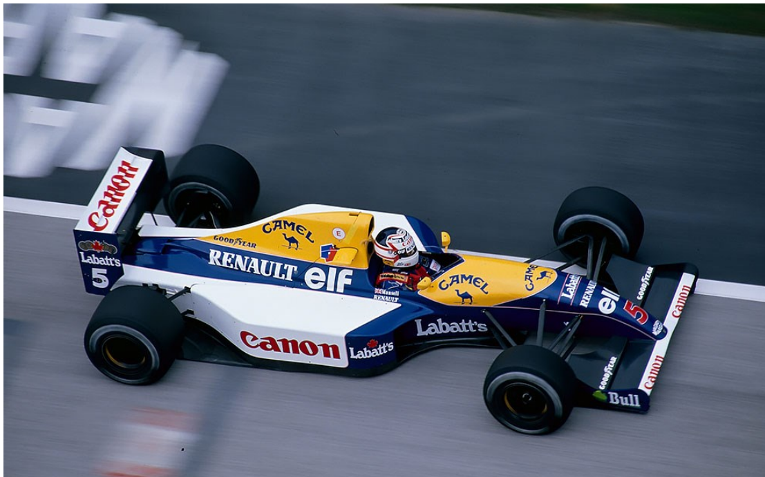
Figura 3.7: Williams FW14B, caratterizzata dal collo di bottiglia nella zona posteriore
