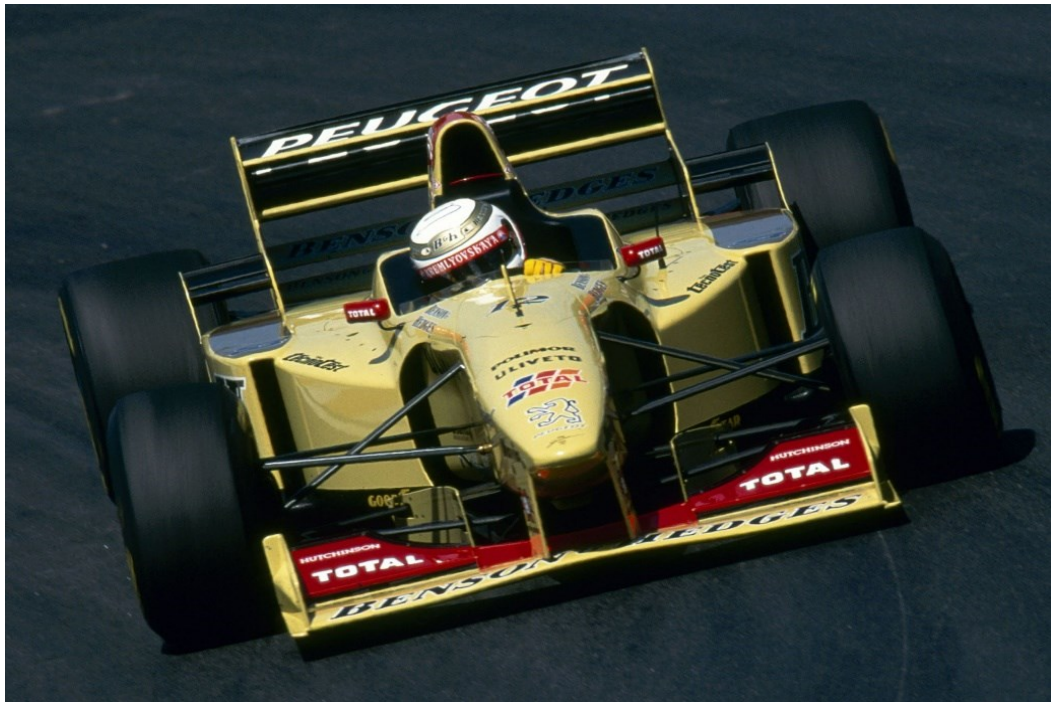
Figura 3.9: Jordan 196 del 1996, dotata di sidepods con due ingressi
