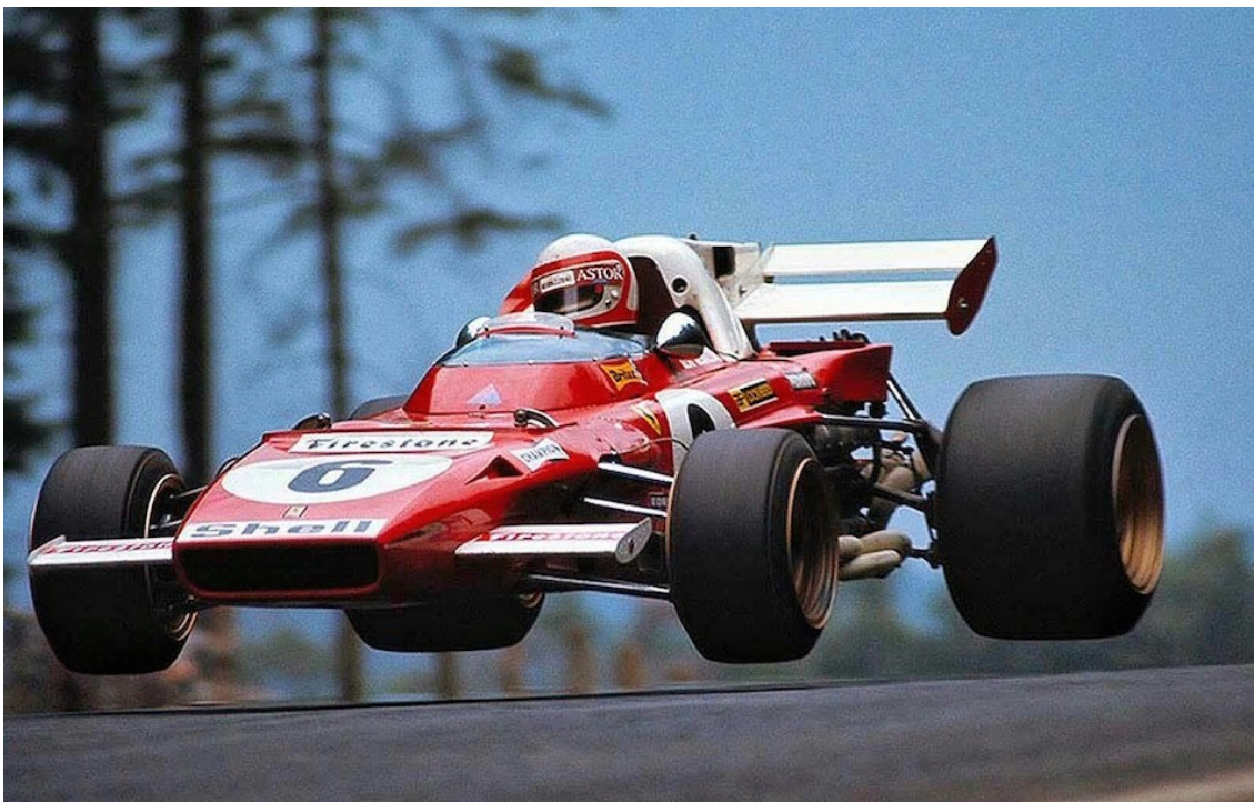
Figura 2.6: La Ferrari 312B, la prima vettura in Formula 1 ad applicare profili aerodinamici
