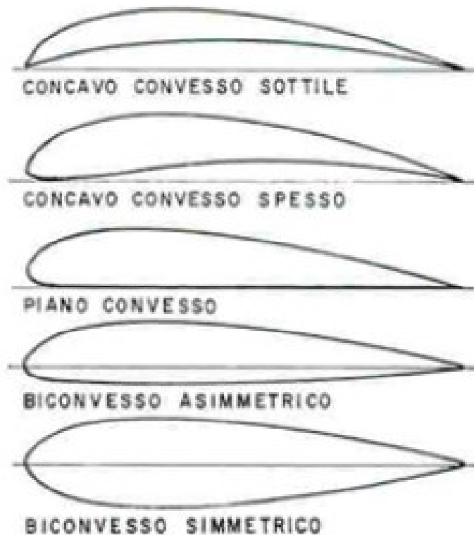
Figura 2.8: Forme dei profili alari
