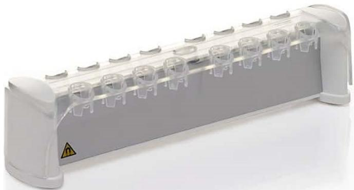
**Figura 16:** Magnetic rack. Le biglie, dove è legato il DNA, vengono attratte dal magnete quindi si posiziona su un lato della eppendorf permettendo, così, la rimozione del sovrantante.
