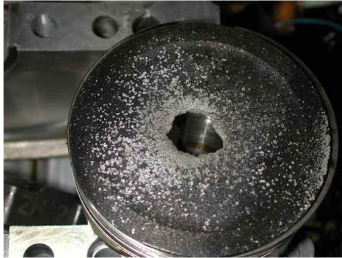
Figura 13 – Pistone danneggiato a causa del battito in testa
