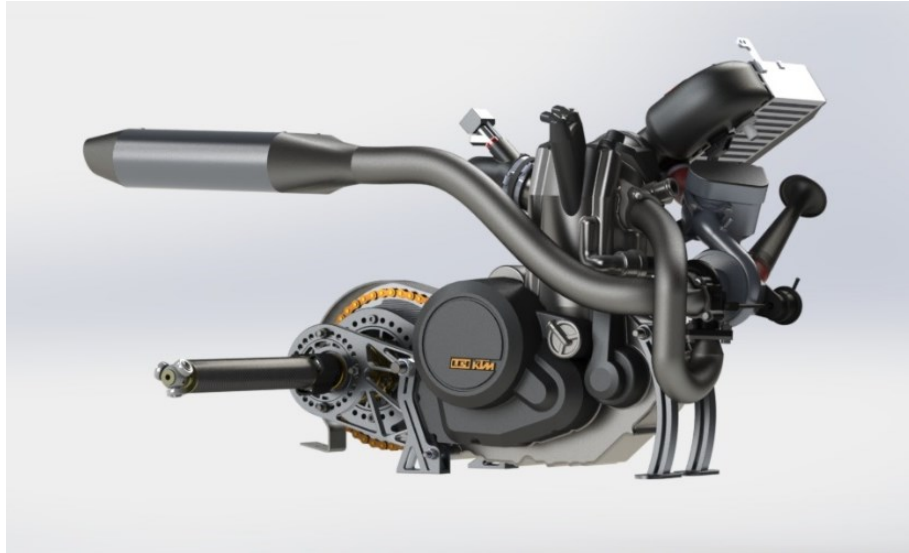
Figura 5 – Motore KTM LC4 sovralimentato
