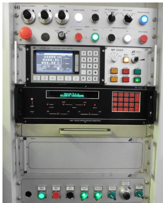
Figura 22 – Torre di controllo del banco prova APICOM
