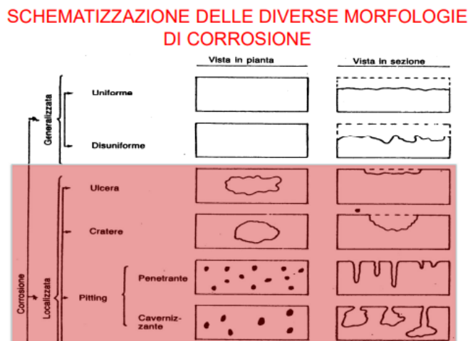
Figura 2.2 - Tipologie di corrosione per pitting
