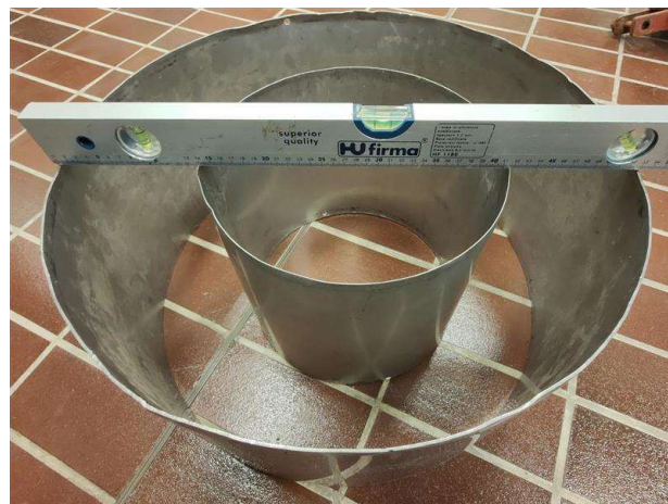
Figura 3.21 Immagine che rappresenta il momento in cui si verifica che i due anelli sono posti alla stessa profondità
