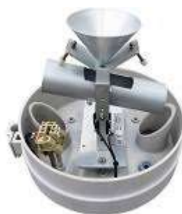
Figura 3.39 Visualizzazione del meccanismo di un pluviometro a bascula
