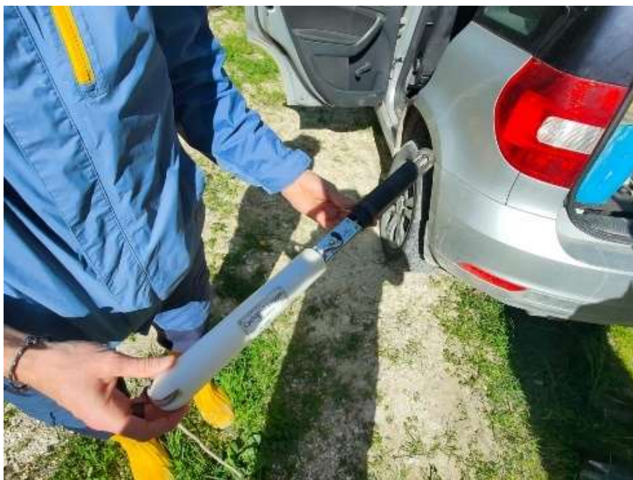
Figura 3.3 (Sonda PME Cyclops-7 LOGGER in mano all'operatore)
