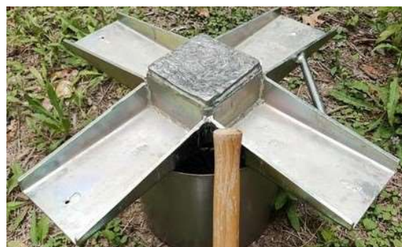
Figura 3.19 Immagine della testa di battuta posta sopra gli anelli prima della loro infissione
