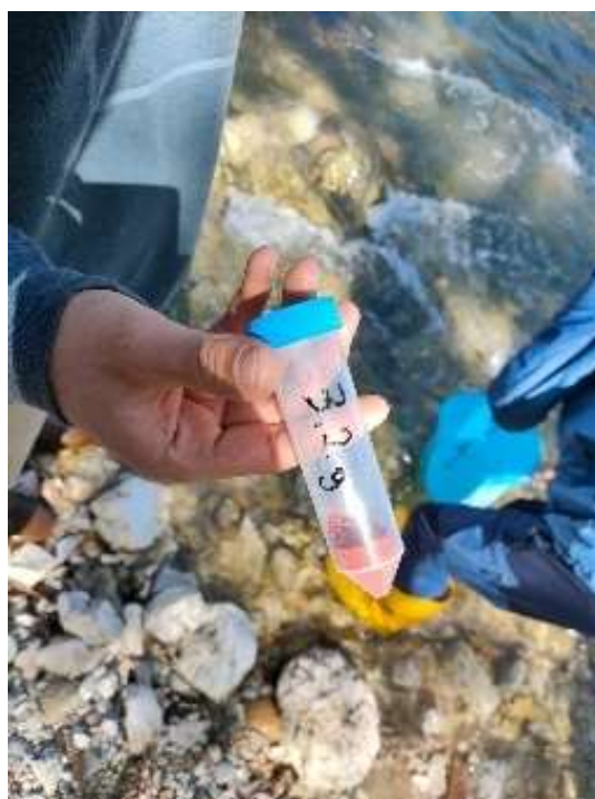
Figura 3.8 Dettaglio della provetta con al suo interno il tracciante in mano all'operatore
