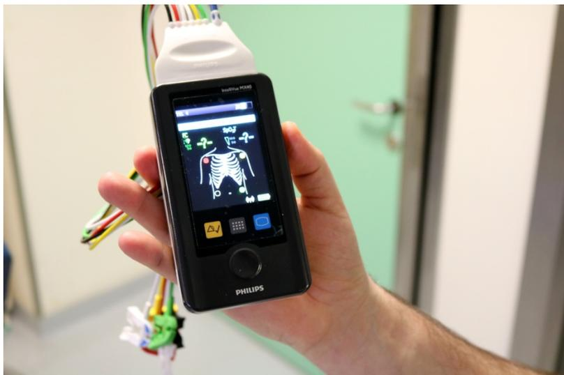
**Figura 10.** Nell'immagine viene raffigurata la telemetria cardiaca mobile che indica la posizione che devono assumere gli elettrodi, i parametri come: FC, SpO2
